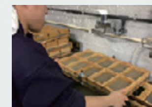
葦と再生パルプを合わせてすく作業
